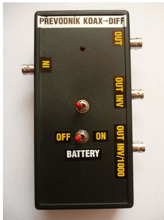
Příloha č. 10 obrázek převodníku mezi nesymetrickým koaxiálním výstupem generátoru a symetrickým diferenciálním vstupem přípravku
