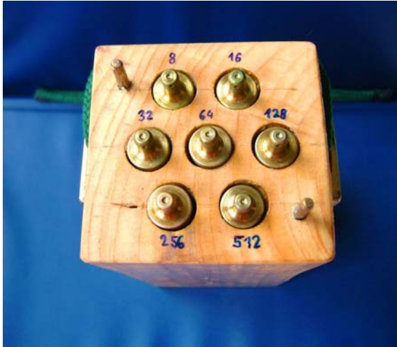
Obr.2 - Souprava kalibrovaných hrotů v ochranném pouzdře
