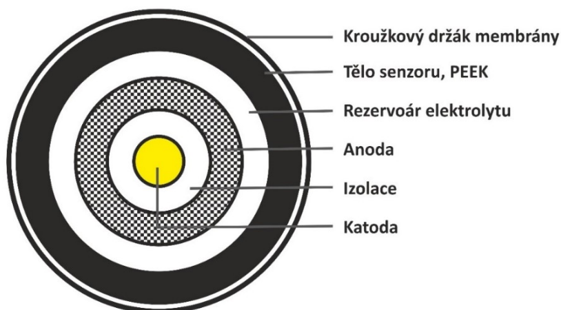
Obr. 36 Průřez polarografickým senzorem v oxygrafu. PEEK – polyetheretherketon (převzato ze zdroje [180] a upraveno)
