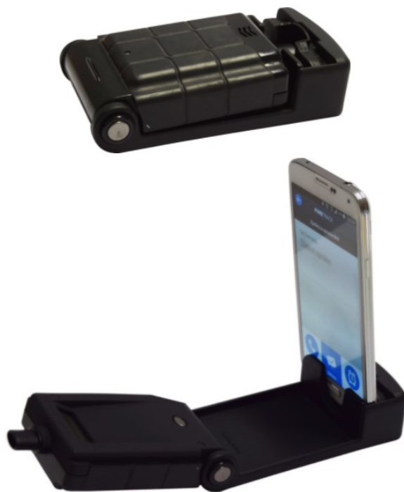
Obrázek 3 Základová stanice pro komunikaci s elektronickým náramkem v období let 2018–2021. 367
