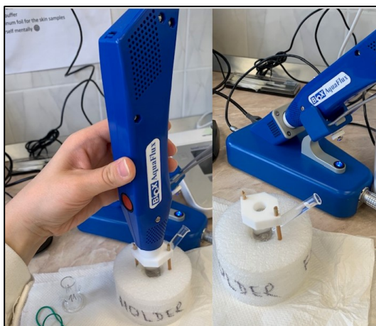
Obrázek 7. Schematické znázornění měření trans-epidermální ztráty vody (TEWL) pomocí přístroje AquaFlux™.
