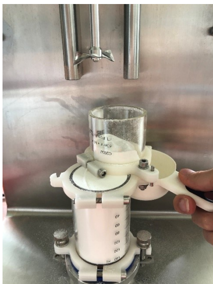
Obrázok 5 Oddelenie hornej časti nádoby od spodnej časti počas testu stability. Hore lopatka.
