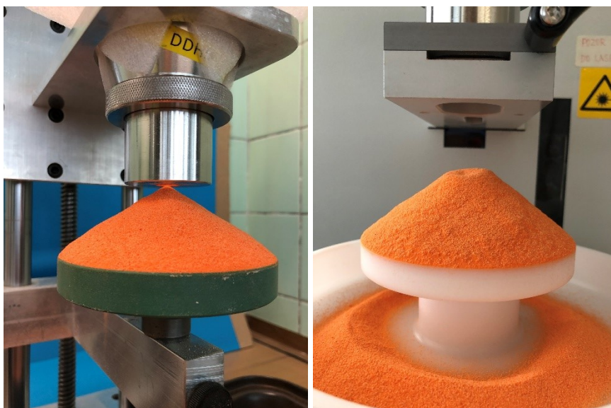
Obrázok 10 Porovnanie vzhľadu kužľa OT pri meraní AOR prístrojom prototyp a Erweka.
