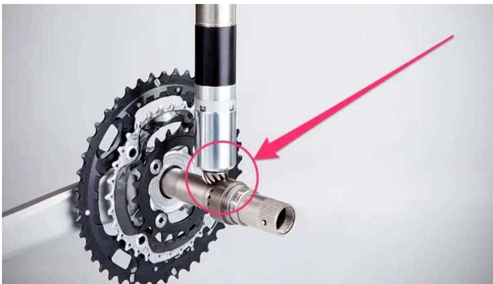
Obrázek 1: Schéma motoru usazeného ve středovém složení a navazující části pohonného systému v sedlové trubce od výrobce Vivax (McMahon, 2016).
