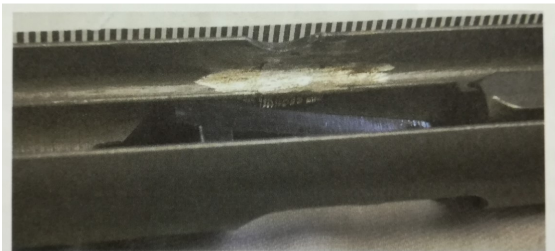
Obr. 8: Stopy po broušení svárů na závěru samopalu vz. 26 ráže 7,62 mm
