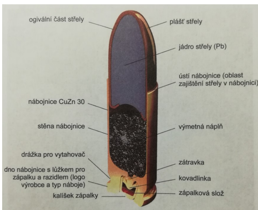
Obr. 3: Části pistolového náboje.
