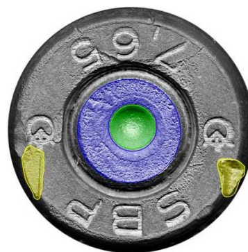
Obr. 10: Značky na nábojnici pro automatické porovnání.
