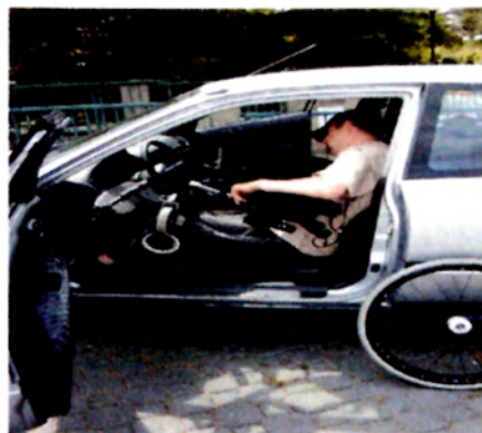
Obrázek č.3b. Naložení vozíku-rozebrání vozíku na jednotlivé díly Zdroj: Archiv autora bakalářské práce
