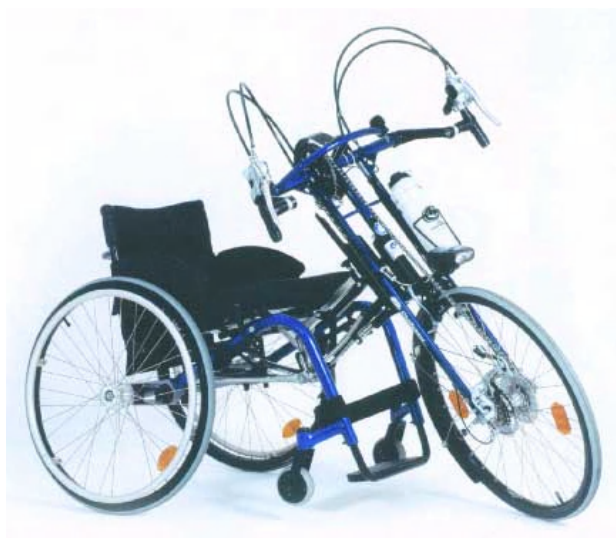
Obrázek 34. Možnost zapojení vlastního mechanického vozíku ke konstrukci pro rekreační cyklistiku.
