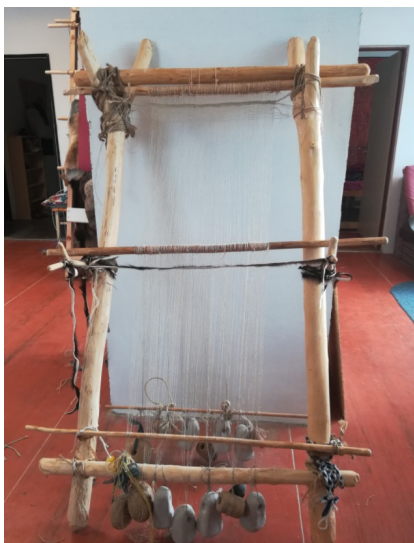
Obrázek 3: Vertikální tkalcovský stav se závažími.
