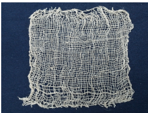
Obrázek 5: Výsledný produkt „plátýnko – síťka“, jednonitka skaná v zákrutu Z, v obou soustavách (osnova i utek) shodný zákrut, textile, vazba plátňová, řídká dostava. Nitě byly po upředění klíženy pro vyšší pevnost, což bylo následně odstraněno praním v horké vodě.
