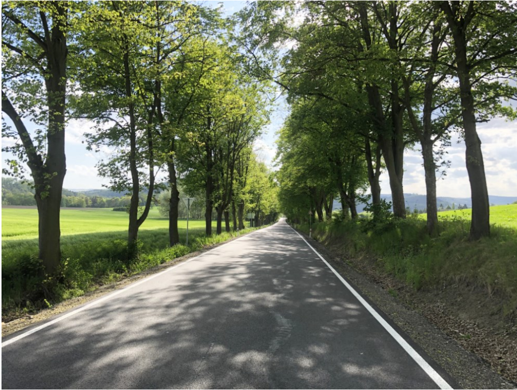
Obr. 4: Alej u silnice č. III./11434 poblíž obce Vatěkov. Stromořadí rostoucí po pravé straně silnice by díky svému růstu na kopci za příkopem bylo bezpečné i pokud by se vyskytovalo u mnohem frekventovanější komunikace 157 .
