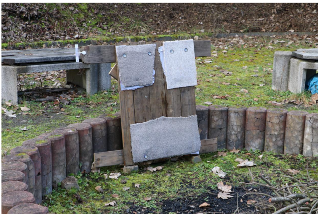
Obrázek 4: dřevěná deska pobitá kusy koberce, látek a kartonu, simulující dveře
