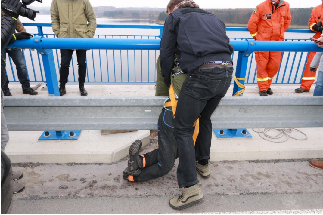
Obrázek 13: Figurant se snaží překonat překážku v podobě svodidla
