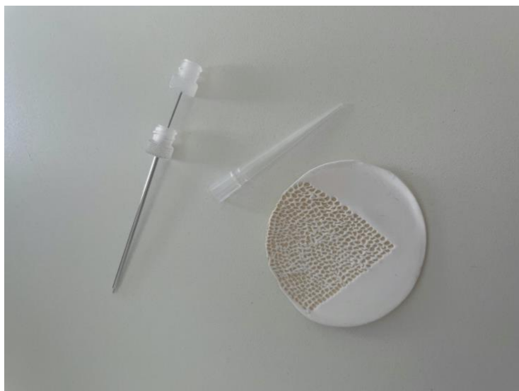
Obr. 3: Souprava nutná pro přípravu špičky u metody \mu -SPE-PT
