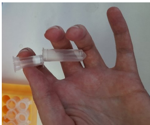
Obrázek 11: Spin filtr naplněný disky z nanovláken a mikrozkuhavka Eppendorf
