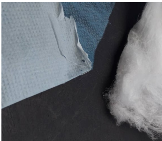
Obrázek 2: Srovnání sorbentu připraveného metodou elektrostatičkého zvlákňování (vlevo) a meltblown (vpravo)
