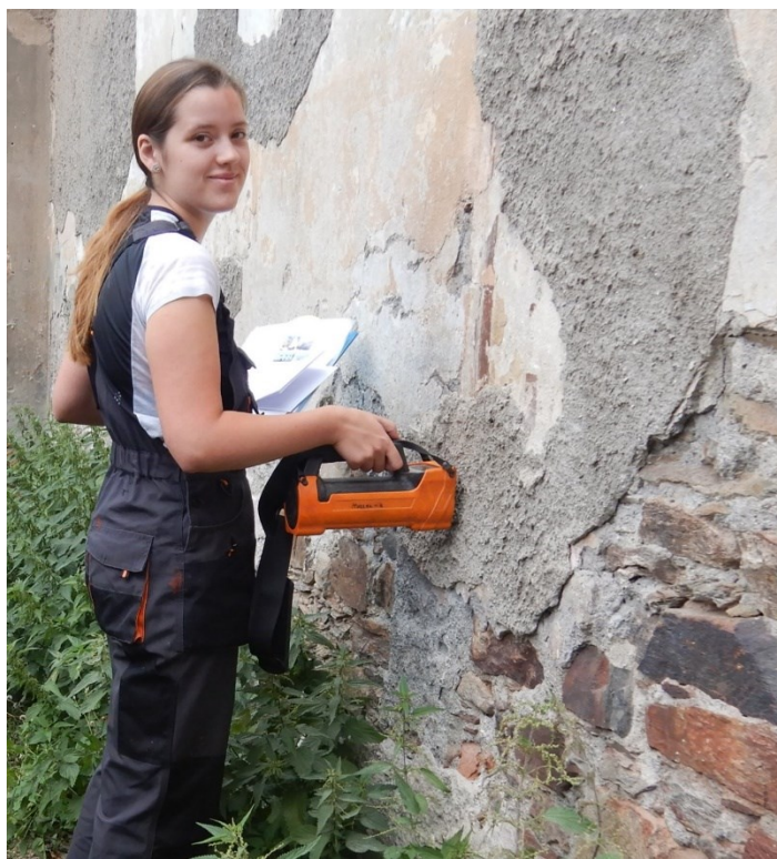
Obr. 7: Měření zdi gama spektrometrem GT-32. Foto V. Goliáš 2022.
