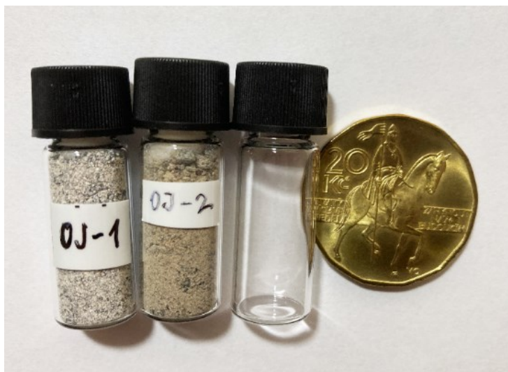
Obr. 10: 2 ml skleněné lahvičky použité pro stanovení ^{226}\text{Ra} v pevných vzorcích. Foto M. Voháňková 2023.
