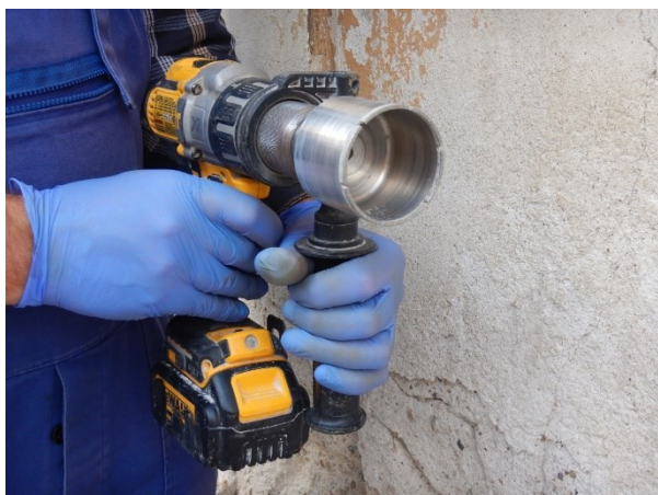
Obr. 8: Odběr vzorků omítek vrtačkou s diamantovou jádrovou vrtnou korunkou o průměru 5,5 cm. Foto V. Goliáš 2022.
