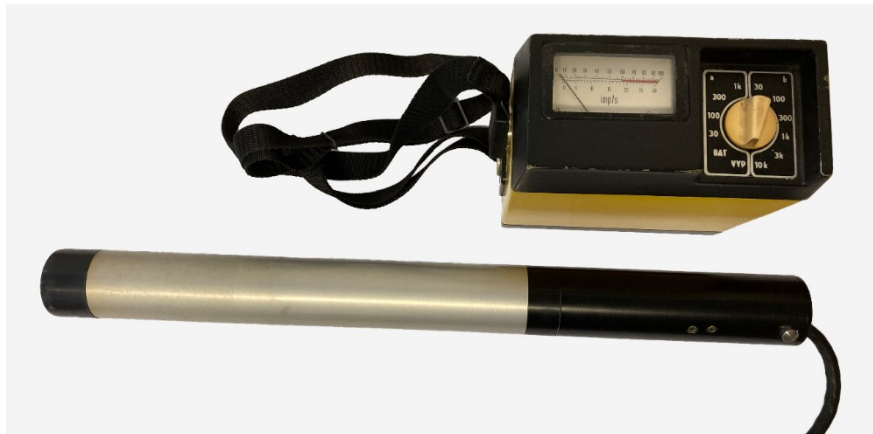
Obr. 6: Terénní scintilační radiometr RP-103 se scintilační sondou NaI(Tl) typu RFS 108 (ZMA). Foto M. Vohánková 2023.
