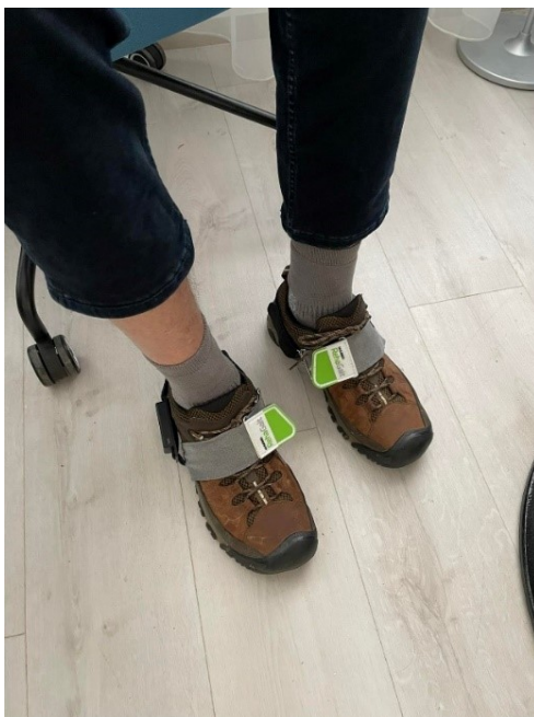
Obrázek 3.3.2.8: Umístění senzorů RehaGait na laterální malleoly (vlastní zdroj, 2022)
