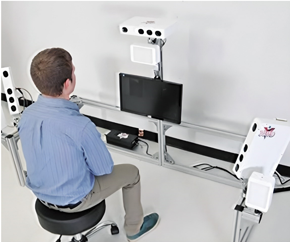
Obr. 4 Snímání stereofotogrammetrickou technikou. Převzato z http://www.4cmedikal.com.tr/en/3dmd-trio-system
