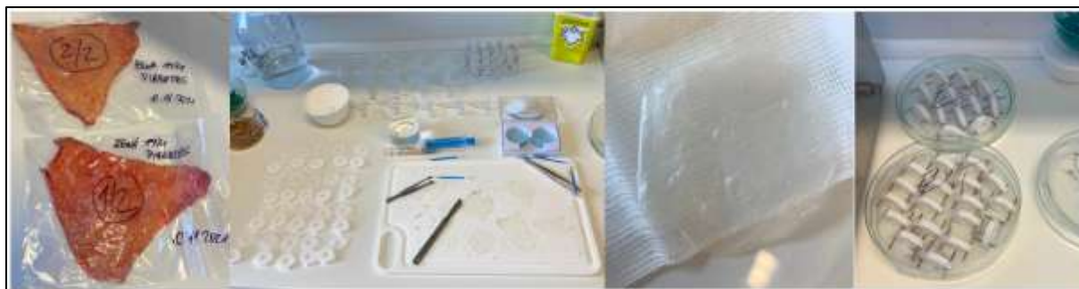
Obrázek 4: Zleva: lidská kůže použita k druhému permeačnímu pokusu, příprava SC na podpůrných filtrech, zblízka připravená SC na filtru, připravené teflonové držáky
