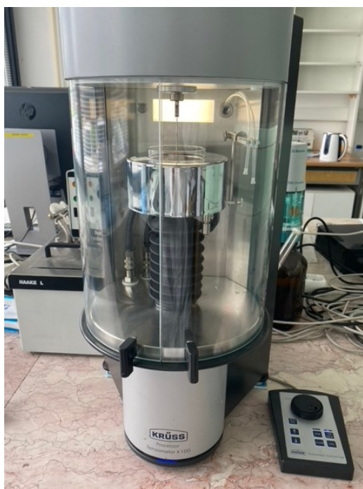
Obrázek č. 13: Fotografie používaného tenziometru Krüss K100.
