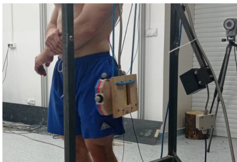
Obr. 54 - Ukázka nárazu kyvadlem do stehna probanda (vlastní fotodokumentace)
