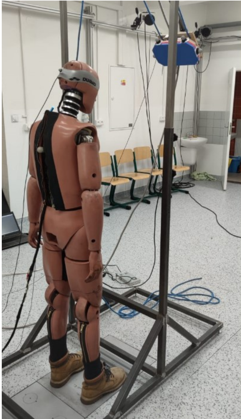
Obr. 55 - Figurína Dummy Hybrid III - experiment (vlastní fotodokumentace)
