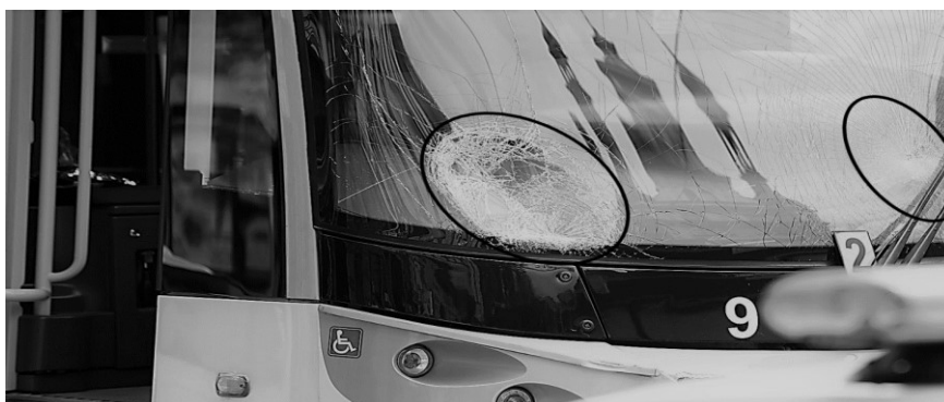
Obr. 6 - Tramvajové čelní sklo po kolizi s kontaktními body (Bittner, a další, 2019)
