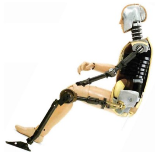
Obr. 43 - Průřez figurínou Hybrid III (Řepová, 2018)
