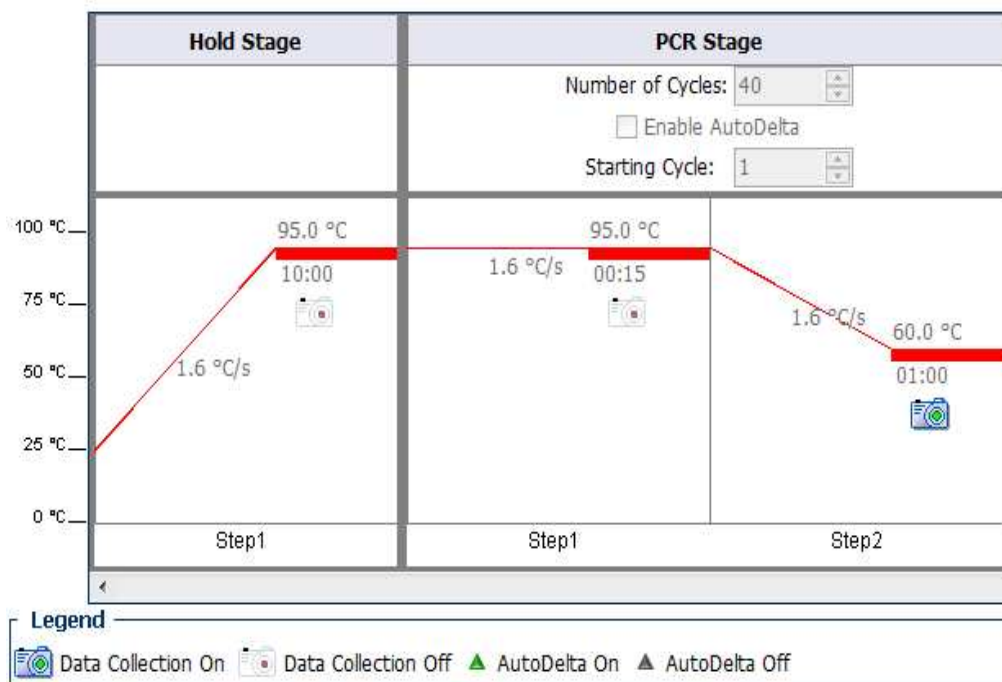
Obrázek 11: Nastavení přístroje QuantStudioTM 6 Flex Real-Time PCR System pro kvantitativní PCR. Zdroj vlastní.
