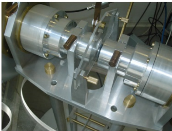
Obr. 2.4: Detektorová časť spektrometra (detektory: fotonásobiče Hamamatsu H3378 s BaF2 scintilátory). [23]
