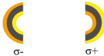
Obrázok 9.: Znázornenie, ako vyzerali vzorky po „symetrizácii“ pomocou dodatočnej vrstvy Kaptonu. Oranžová vrstva znázorňuje substrát na ktorom je STE a žltá vrstva znázorňuje dodatočnú vrstvu Kaptonu.
