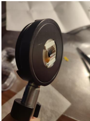
Obrázok 10.: Kovový držiak a prvé prehnutie vzorky pomocou obojstrannej lepiacej pásky.
