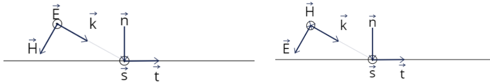
Obrázek 2: Definice vektorů zmíněných v textu v koplanární geometrii pro S polarizaci (vlevo) a pro P polarizaci (vpravo). V levém obrázku vektory \mathbf{E} a \mathbf{s} míří směrem z nákresny a ostatní vektory leží v rovině nákresny, která je shodná s rozptylovou rovinou. V pravém obrázku vektor \mathbf{H} míří směrem do nákresny, vektor \mathbf{s} směrem z nákresny a ostatní vektory leží v rovině nákresny, která je opět shodná s rozptylovou rovinou. Povrch vzorku je kolmý na nákresnu.
