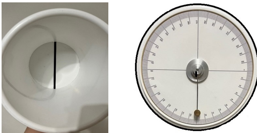
Obr. 6 a 7: Detaily kyblíku pro Bucket metodu, čára na dně a stupnice na zevní straně (archiv autorky).
