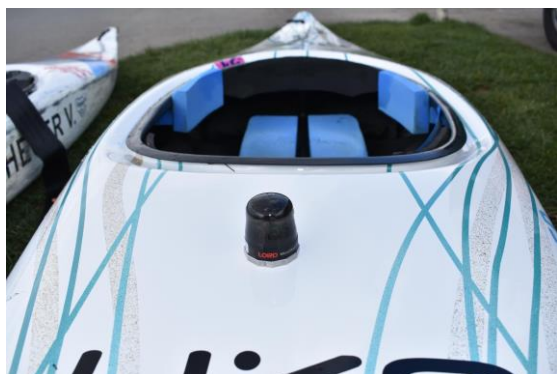
Obrázek 8: Akcelerometr umístěný na palubě kanoe
