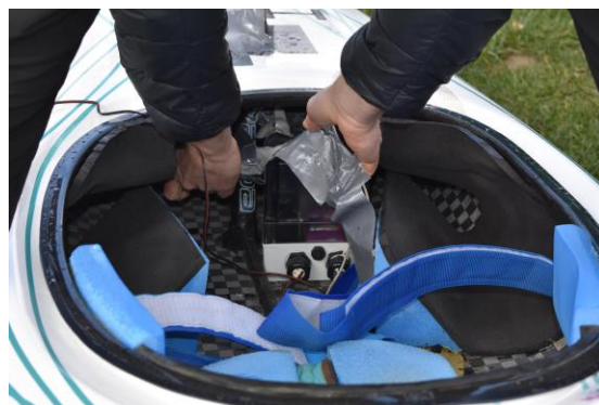
Obrázek 9: Fixace měřicí jednotky v kanoi
