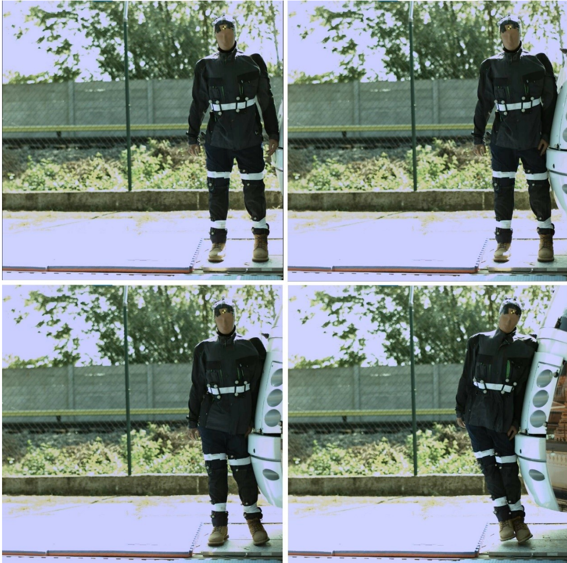
Obrázek 24 – sekvence srážky s tramvají 14T, vlevo nahoře první kontakt s rukou, vpravo nahoře kontakt s pánví, vlevo dole začátek zrychlení hrudníku a vpravo dole unášení figuríny
