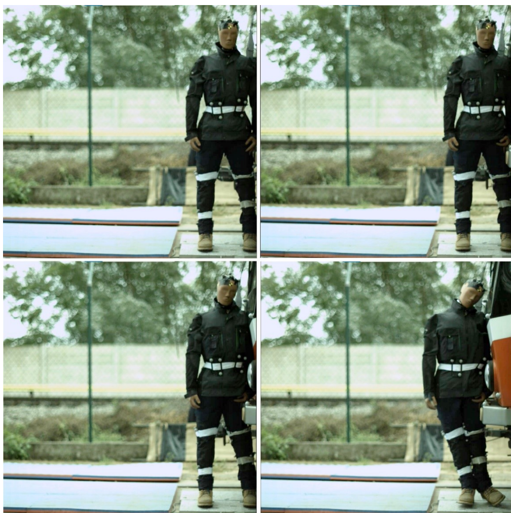
Obrázek 22 – sekvence srážky s tramvají KT8D5, vlevo nahoře první kontakt s rukou, vpravo nahoře kontakt s pánví/hrudníkem vlevo dole začátek zrychlení pánve/hrudníku a vpravo dole unášení figuríny
