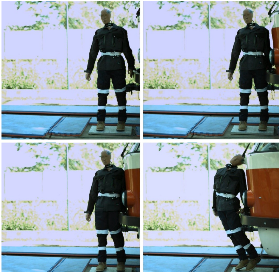
Obrázek 20 – sekvence srážky s tramvají T3, vlevo nahoře první kontakt s rukou, vpravo nahoře kontakt s pánví, vlevo dole kontakt s hrudníkem a vpravo dole unášení figuríny
