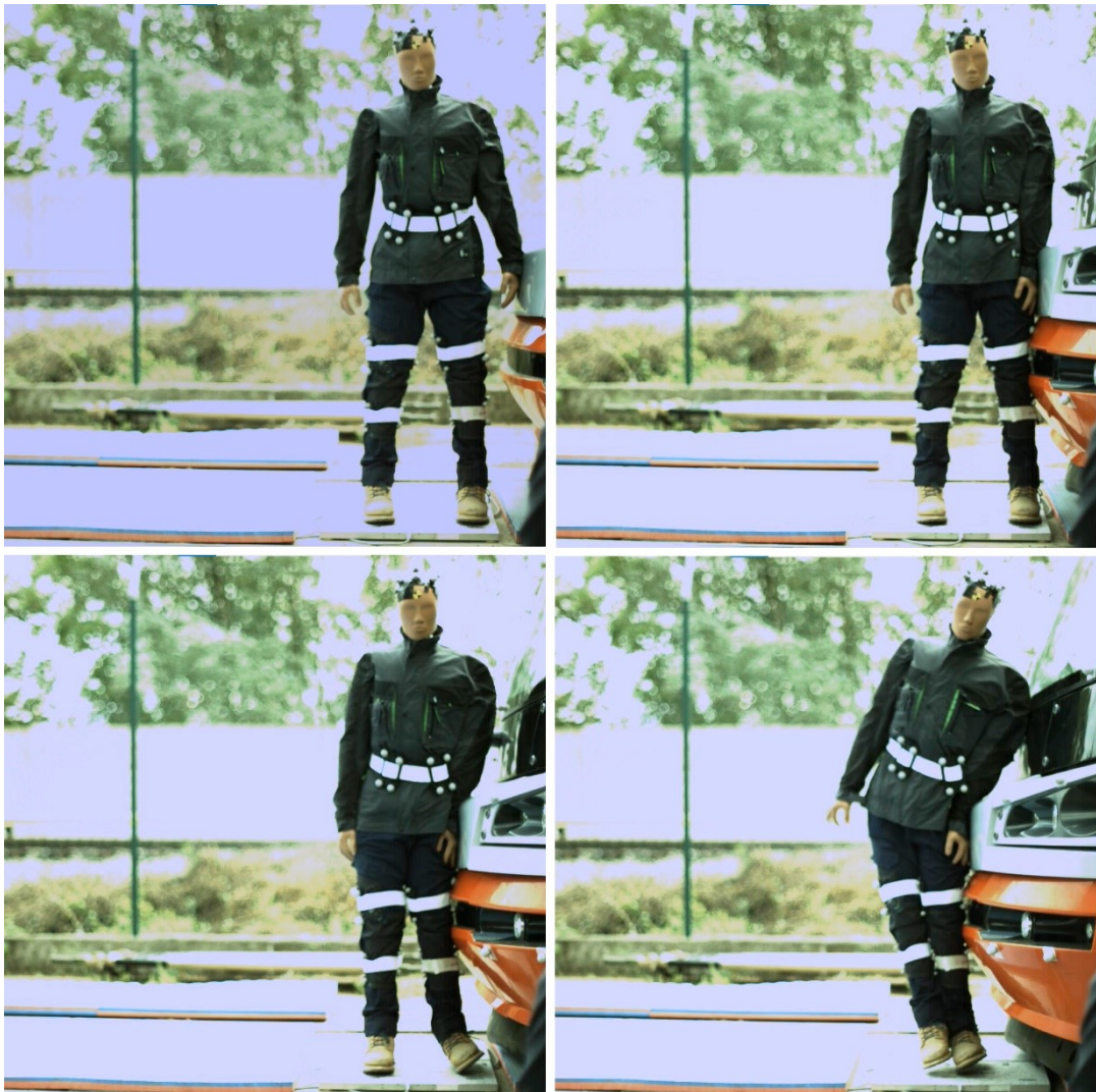
Obrázek 26 – sekvence srážky s tramvají 15T, vlevo nahoře první kontakt s rukou, vpravo nahoře kontakt s pánví, vlevo dole začátek zrychlení hrudníku a vpravo dole unášení figuríny
