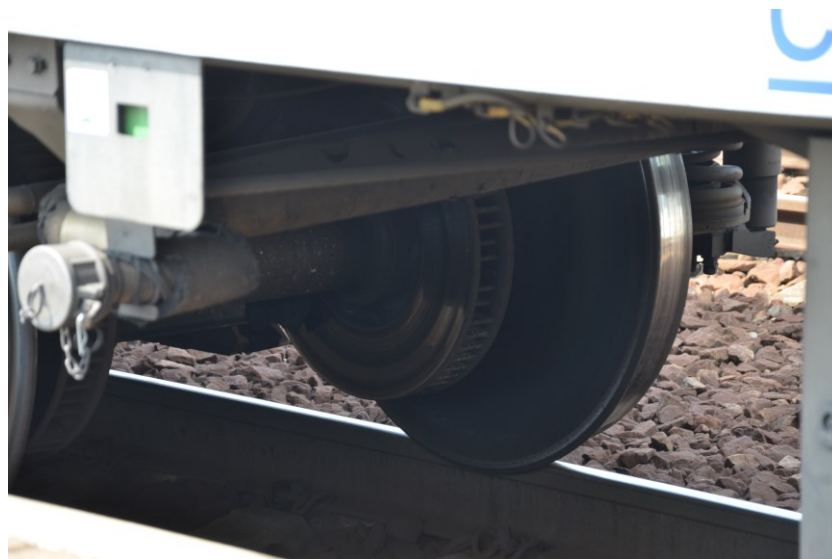
Obrázek 12: Okolek. Z vnitřní strany kolejnice je vidět, že okolek zasahuje níž než je její horní hrana.
