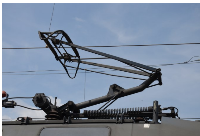
Obrázek 16: Sběrač lokomotivy (polopantograf). Ve spodní části je vidět pružina, pomocí níž je sběrač přitlačován k troleji.
