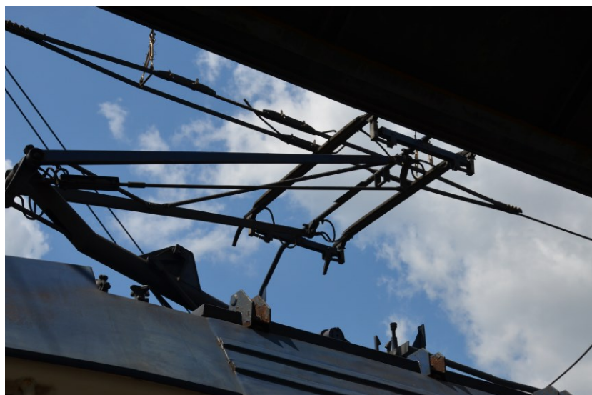
Obrázek 36: Vlak projíždějící pod děličem se zvednutým sběračem na Hlavním nádraží v Praze.
