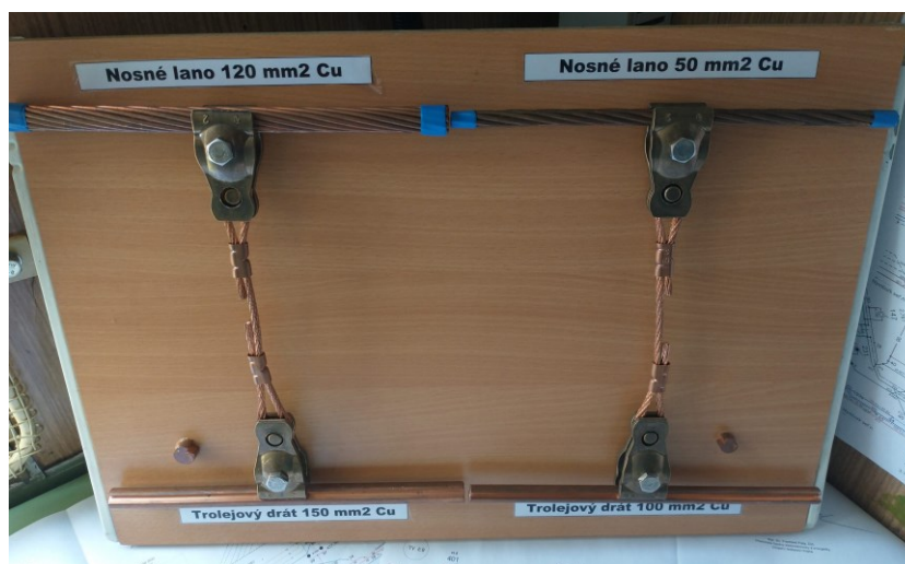
Obrázek 32: Průřezy trolejí a nosných lan [19]. Vlevo nosné lano s průřezem 120 \text{ mm}^2 nese trolej s průřezem 150 \text{ mm}^2 . Vpravo nosné lano s průřezem 50 \text{ mm}^2 a trolej s průřezem 100 \text{ mm}^2 .
