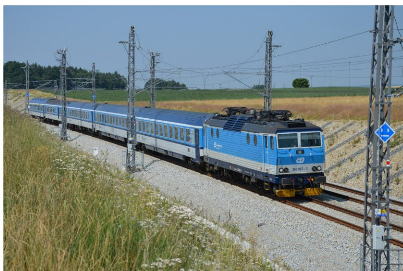
Obrázek 39: Průjezd vlaku pod neutrálním polem se staženým sběračem.
