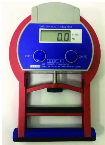
Obrázek 9: Ruční dynamometr Takei, A5401, Japonsko (Chan Ha, 2018)
