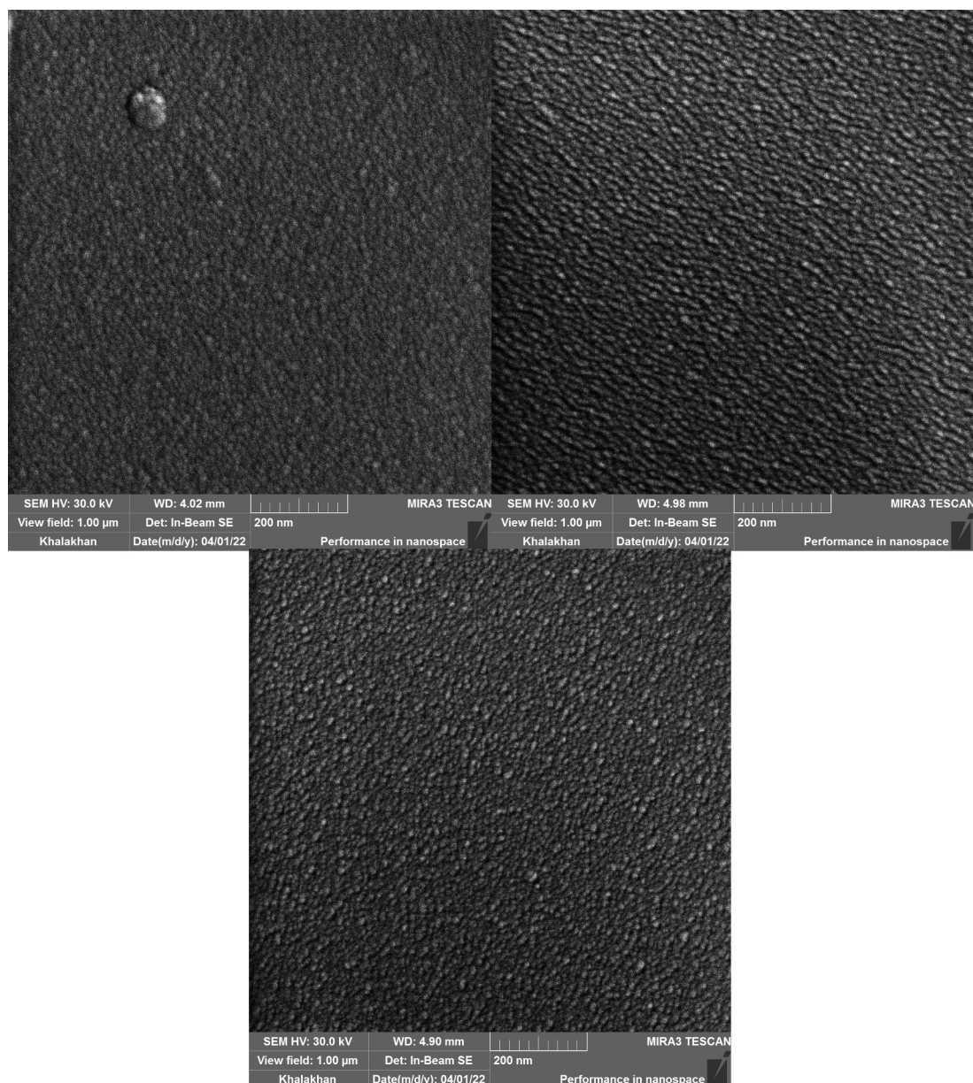
Obr. 3.1 Snímky povrchu vzorků, napařovaných na silikonový substrát. Pořízeno pomocí SEM. Vlevo nahoře: \text{Pt}_{25}\text{Cu}_{75} , vpravo nahoře: \text{Pt}_{50}\text{Cu}_{50} , dole: \text{Pt}_{75}\text{Cu}_{25}
