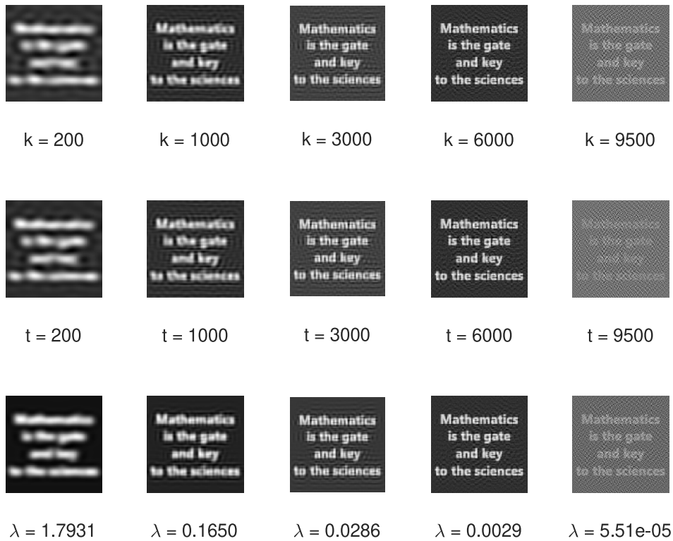
(c) Rekonštrukcie metódami T-SVD( k ), T-TLS( t ) a Tich( \lambda ), pre vybrané parametre
