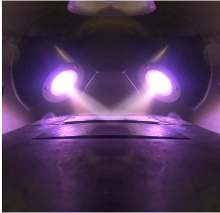
Obrázek 8: Fotografie dvou magnetronových hlavic při depozici.
