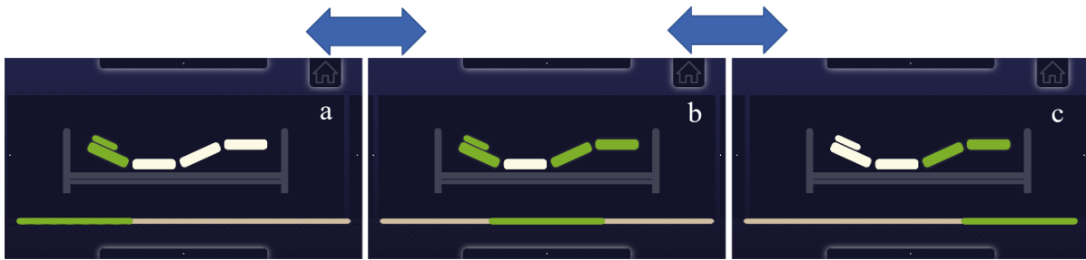
Obr. 9 Zobrazení tří variant obrazovek pro ovládání a výběr tří základních segmentů. Jednotlivé obrazovky symbolizují vybraný segment a zleva: poloha hlavy, b uprostřed: poloha hlavy a nohou, c vpravo: poloha nohou. Modré šipky představují možné přesuny mezi segmenty, pokud uživatel zrakově fixuje postranní elementy obrazovky.
