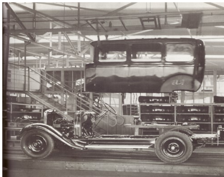
Výroba karoserií v karosárně a výroba podvozků v mechanice. Výsledné spuštění karoserie na podvozek. 115
