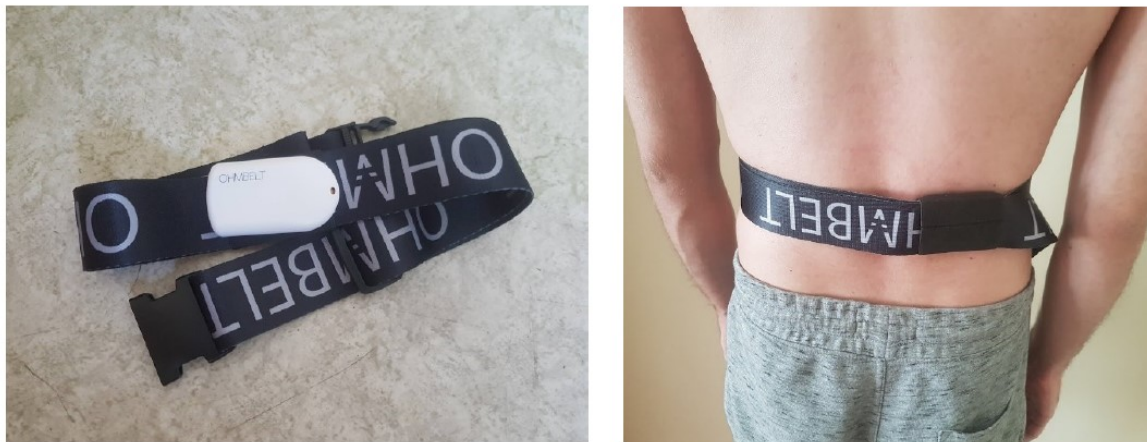
Obrázek 3. OhmTrak (dříve nazývaný OhmBelt) senzor (vlevo) a jeho umístění na trupu (vpravo) (Tyburcová M, 2022)
