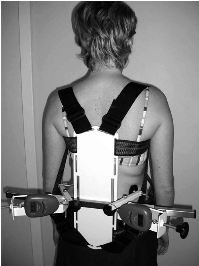
Obrázek 2. Dynamometr (Malátová et al. 2007) a jeho upevnění na trup.
