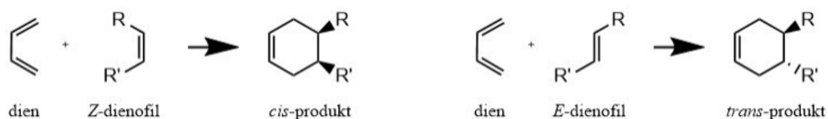
Schema 13 Stereoizomerie substituentů dienofilu
