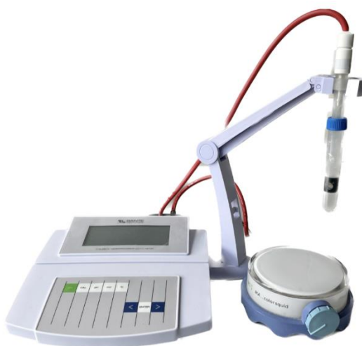
Obrázek 2: Laboratorní pH metr
