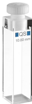
Obrázek 11 | Křemenná kyveta firmy Hellma Analytics, dostupná na [68].
