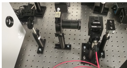
Obrázek 13 | V levé části: Schéma setupu pro měření PLE: 1 - laser s laditelnou vlnovou délkou, 2 - polarizační filtr, 3 - držák kyvet, 4 - beam-block, 5 - čočka a kolimátor k navázání do optického vlákna, 6 - optické vlákno, 7 - spektrometr. V pravé části: Fotografie setupu z laboratoře.
