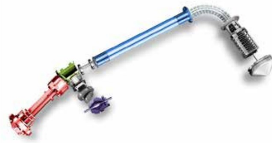
Obrázek 6: Schematické uspořádání jednotlivých kompartmentů v analyzátoru typu Orbitrap Q Exactive: kvadrupól (modrá), C-trap (zelená), vysoko-energetická kolizní cela (HCD) (červená), orbitrap analyzátor (fialová). [148]
