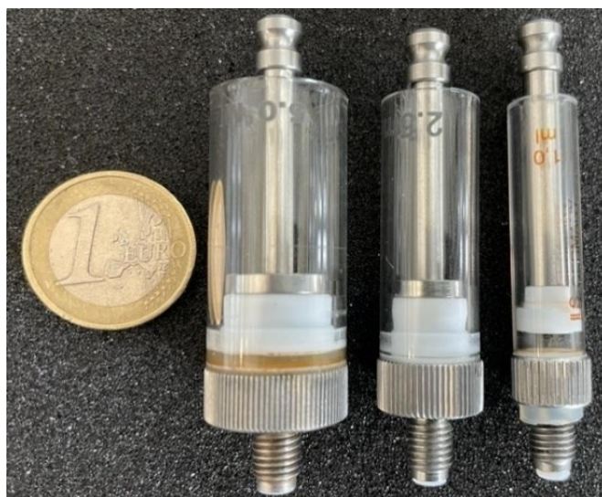
Obrázek 17. Různé velikosti injekčních stříkaček v LIS. Zleva: 5 ml; 2,5 ml; 1 ml
