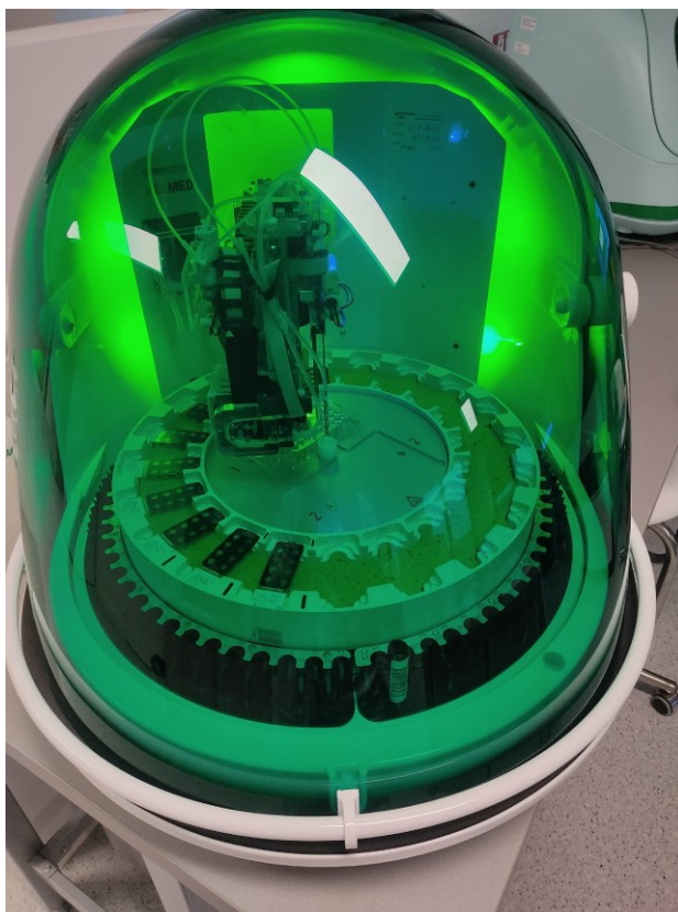
Obr. 19: Automatický přístroj pro zpracování IF sklíček Helmed Processor
