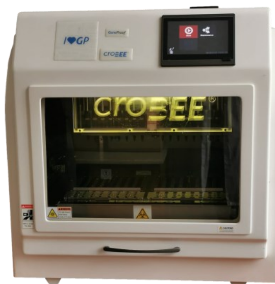
Obr. 30: Automatický izolátor croBEE NA16 NucleicAcid Extraction System Plus
