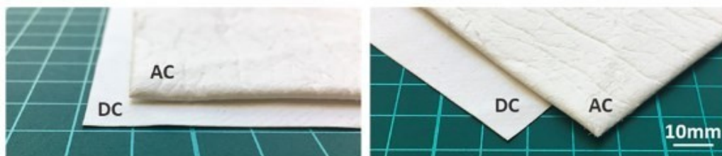
Obrázok 13 Obrázky nanovláknenných sorbentov PA 6 zvlákňovaných AC a DC technikami.
