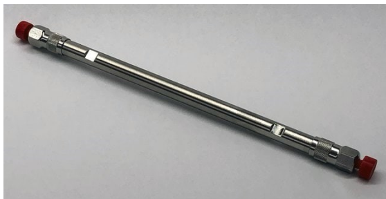
Obrázek 7: Chromatografická kolona SUPELCO Ascentis Express C-18 100*4,6 mm, částice 2,7 \mu\text{m} .
