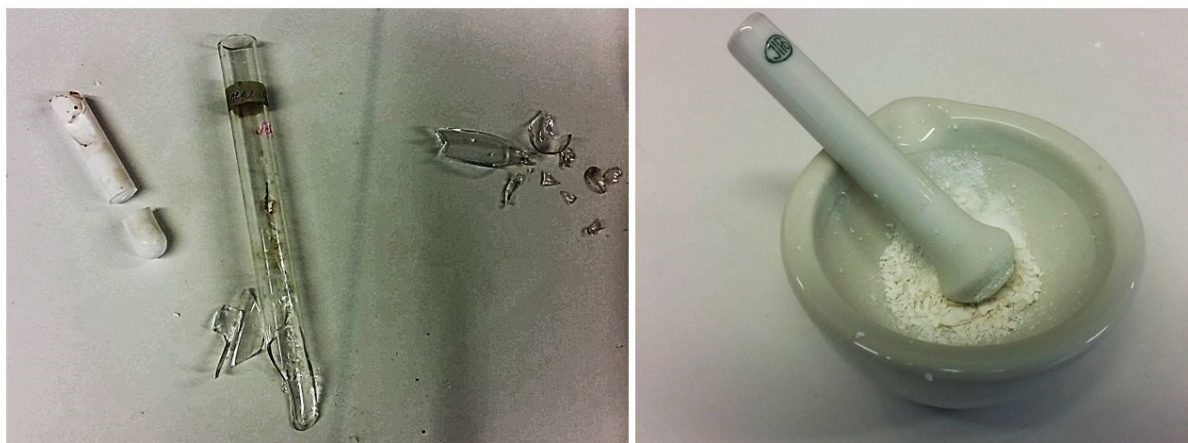
Obrázek 10: Ukázka vzniklého bloku polymeru a jeho drcení před plněním do cartridge.
