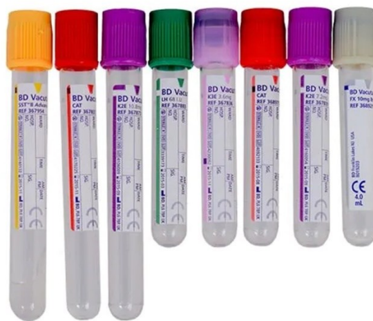
Obr. 8 Příklad barevného odlišení vybraných zkumavek dle přidaného aditiva systému Vacuette® (Greiner Bio-One, Rakousko). Žlutá/zlatá zkumavka s aktivátorem srážení a separačním gelem, červené zkumavky s aktivátorem srážení, fialové s EDTA, zelená s heparinem a šedá s NaF [77]
