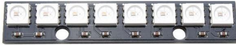
Obrázek 17 - RGB LED modul 8 x NeoPixel WS2812 - přední část 22
