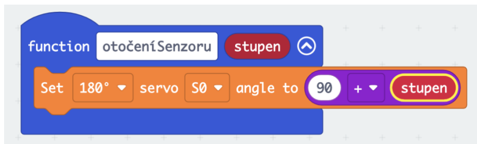
Obrázek 33 - Nastavení pohybu předního senzoru vzdálenosti 39
