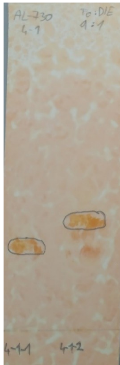
Obrázek 17 TLC podfrakce AL-730-4-1 – soustava To:Et 2 NH 9:1, detekce Dragendorffovým činidlem
