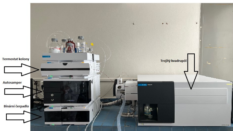
Obrázek 10: LC sestava Agilent 1290 Infinity II s trojitým kvadrupólem Agilent 6495 (Agilent Technologies, USA)
