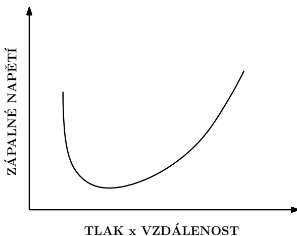
Obrázek 1.1: Paschenův zákon — závislost zápalného napětí na součinu p \times d .
